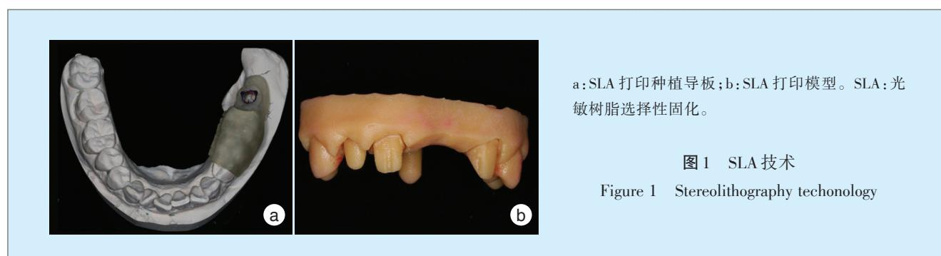
a:SLA打印种植导板;b:SLA打印模型。SLA:光敏树脂选择性固化。
