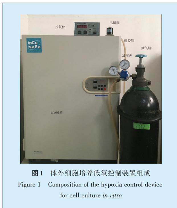
图1 体外细胞培养低氧控制装置组成
